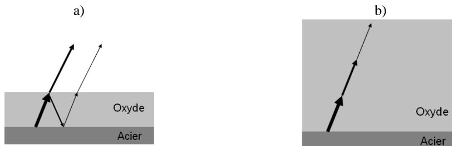
Figure 6: Couche mince d'oxyde sur un substrat d'acier – avec a) une faible épaisseur et b) une forte épaisseur d'oxyde
