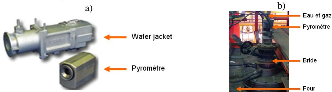
Figure 3 : a) Image d'un pyromètre industriel et b) d'une installation industrielle
