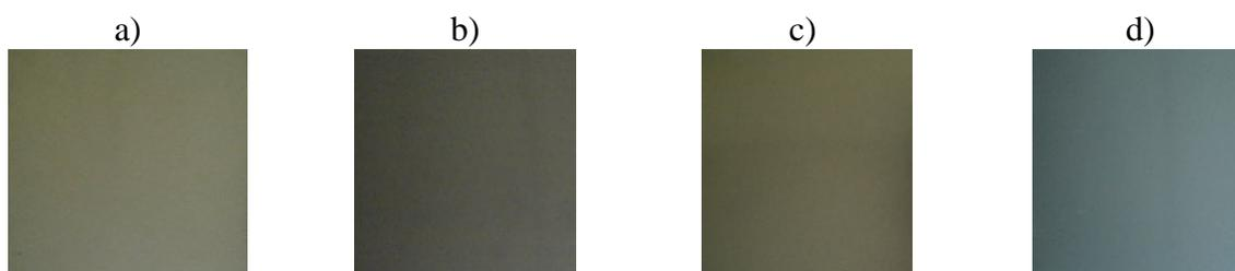
Figure 6 : Quatre échantillons d'acier recouverts d'une couche d'oxyde de silicium de différentes épaisseurs : a) 25 nm, b) 40 nm, c) 52 nm et d) 96 nm
