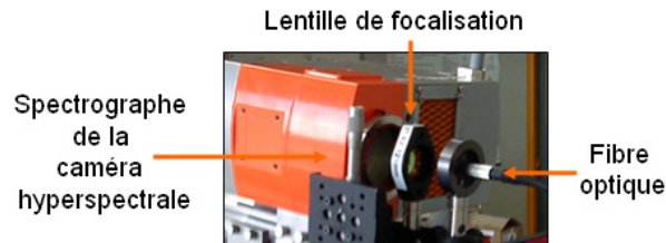
Figure 7 : Premier couplage d'une caméra hyperspectrale 8-12 \mu\text{m} avec une fibre optique
