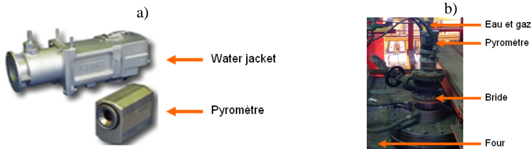
Figure 3 : a) Image d'un pyromètre industriel et b) d'une installation industrielle
