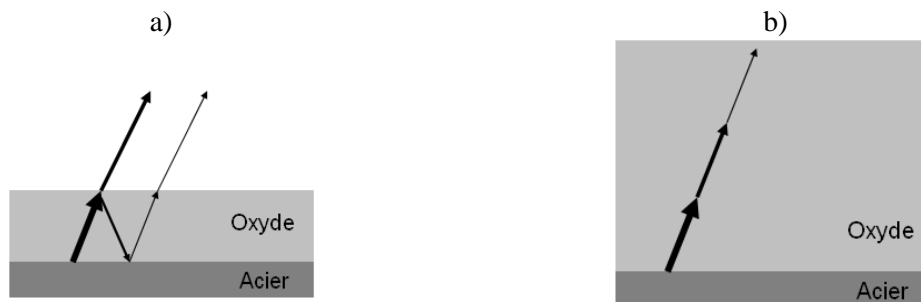
Figure 6: Couche mince d'oxyde sur un substrat d'acier – avec a) une faible épaisseur et b) une forte épaisseur d'oxyde
