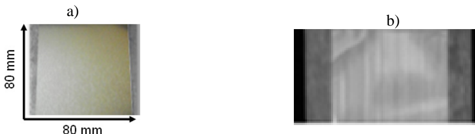
Figure 2: Image de l'échantillon avec environ 100 nm de \text{SiO}_2 sur une surface d'acier a) en couleur (RVB) et b) en niveau de gris à \lambda = 8,06 \mu\text{m} obtenu avec la caméra hyperspectrale
