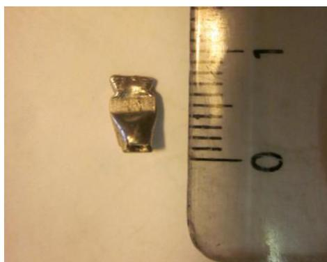
**Figure 2.6** : schéma du système de chargement des gaz rares dans la capsule. L'entrée du tube est directement connectée à la capsule par emboîtement, le tout relié à une vanne manuelle qui permet, soit de pomper dans la capsule, soit d'injecter les gaz rares depuis un réservoir. La photo à gauche montre la capsule finale prête pour une expérience de HP/HT.
