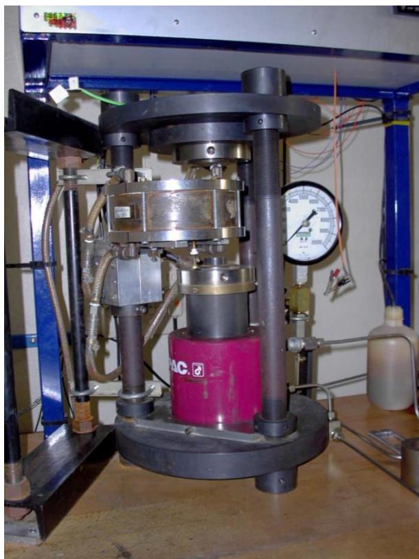
Figure 2.5: Piston-cylindre sans contre-pression du Laboratoire Magmas et Volcans, Clermont-Ferrand.
