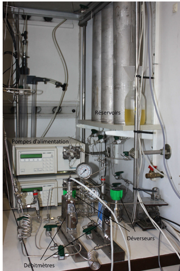
Figure 3.3 – Photographie rapprochée du bloc d'alimentation du pilote.
