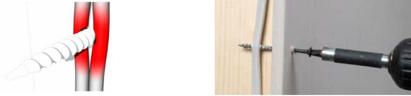
Figure 1.27. Isolement du câble endommagé par perforation [35, 36]
