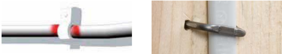
Figure 1.28. Isolement du câble endommagé par le dispositif de serrage [35, 36]
