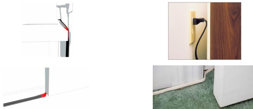
Figure 1.26. Câble ou isolement endommagé dû à une mauvaise installation [35, 36]
