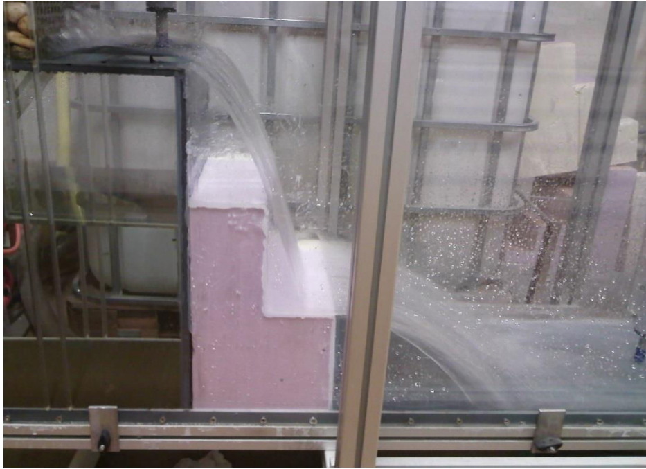
Figure -III-13- Écoulement sur une cascade avec h = 16,5 cm et l = 10 cm
