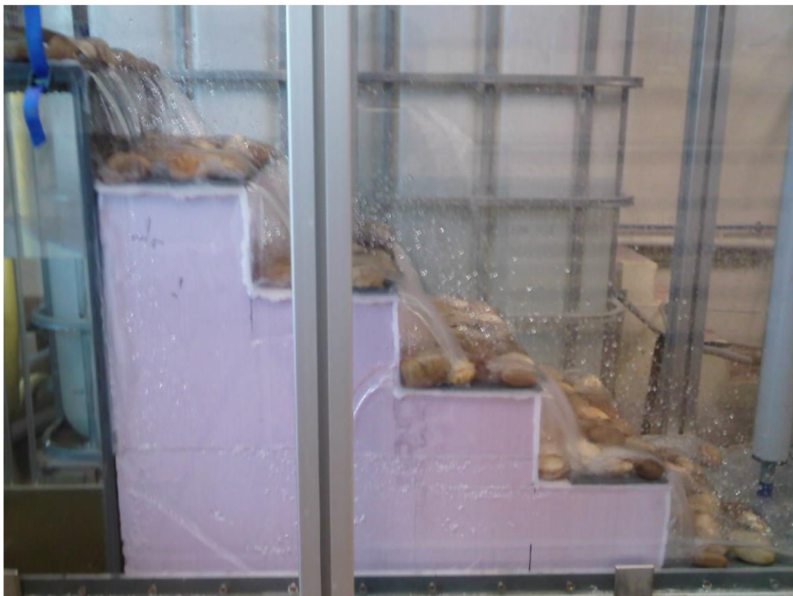
Figure -III-22- Écoulement sur une cascade avec des graviers
