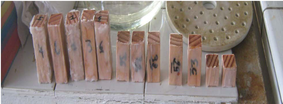
Figure IV 5: Echantillons après application de la résine
