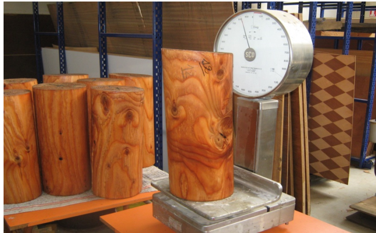
Figure V 4 : Balance OHAUS de 250 kg de portée maximale et de 10 g de précision
