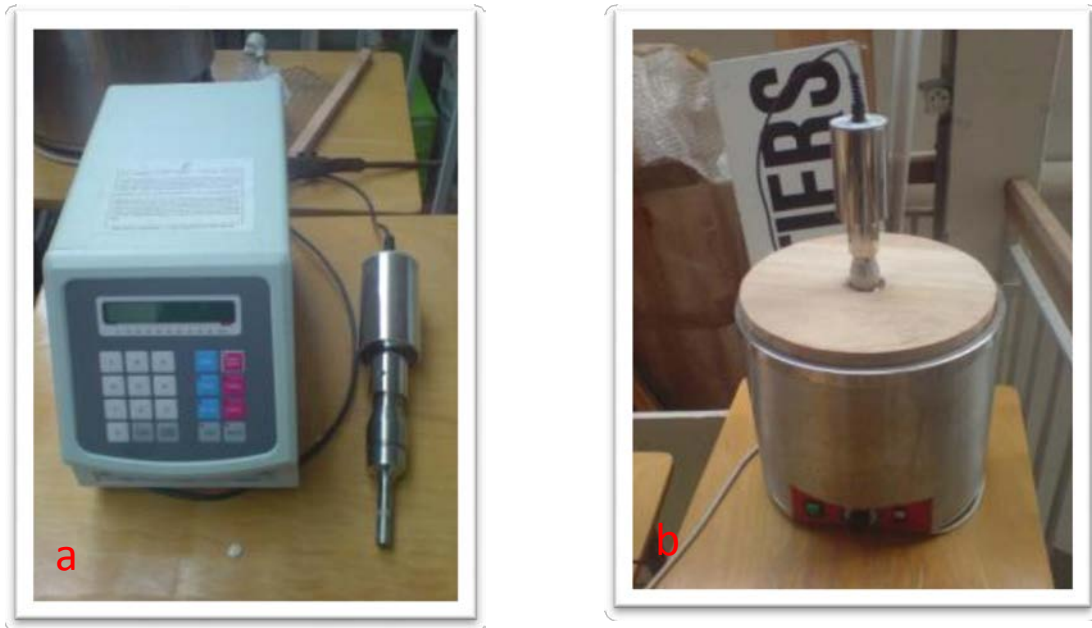
Figure III 13: (a) Générateur et sonde à ultrasons, (b) Dispositif d'immersion et d'exposition aux ultrasons
