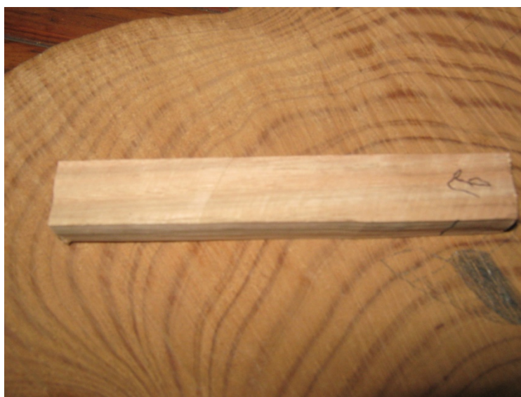
Figure III 4 : Eprouvette de 2 \times 2 \times 12 \text{ cm}^3
