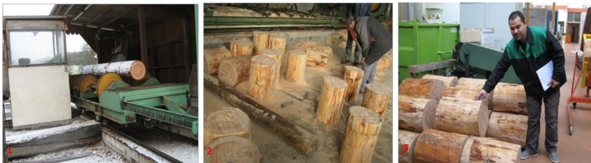
Figure III 2.: (1) Ecorçage, (2) débitage et (3) marquage des billons
