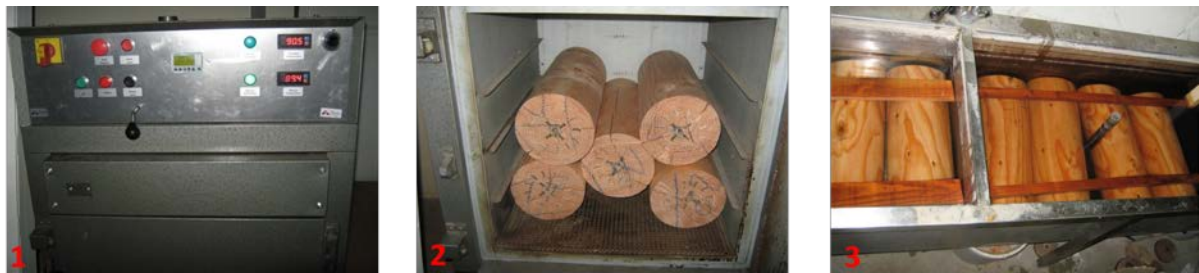
Figure V 3: (1) et (2) Séchage thermique dans un séchoir ventilé (3) Immersion des billons dans des bacs d'eau
