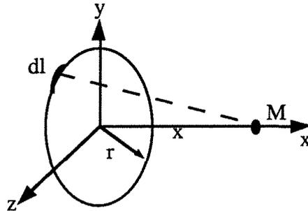
Figure B.11 : Paramètres géométriques relatifs au calcul du champ électrique créé par une spire.
