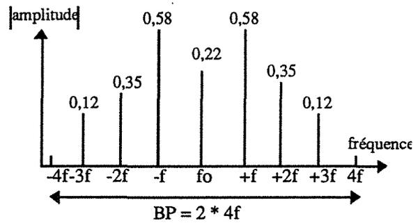
Figure B.17 : Spectre d'amplitude d'un signal F.M. ( $\beta = 2$ )
