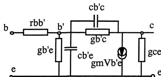
Figure C.5 : Schéma du transistor en petits signaux
