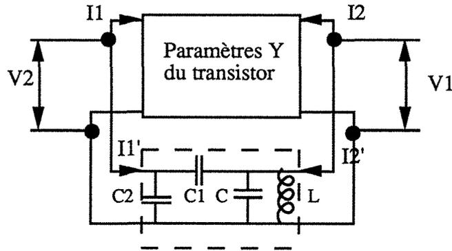
Figure C.11 : Représentation de l'oscillateur sous forme de quadripôles.
