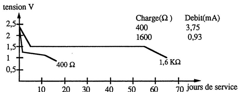
Figure B.39 : Décharge caractéristique d'une pile Lithium
