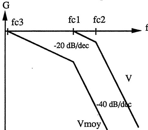
Figure C.33 : Courbes de transfert du montage
