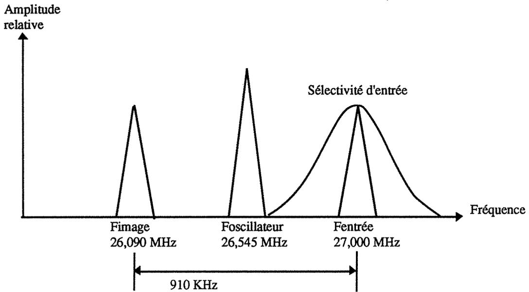
Figure B.44 : Conversion infradyne d'un récepteur 27 MHz
