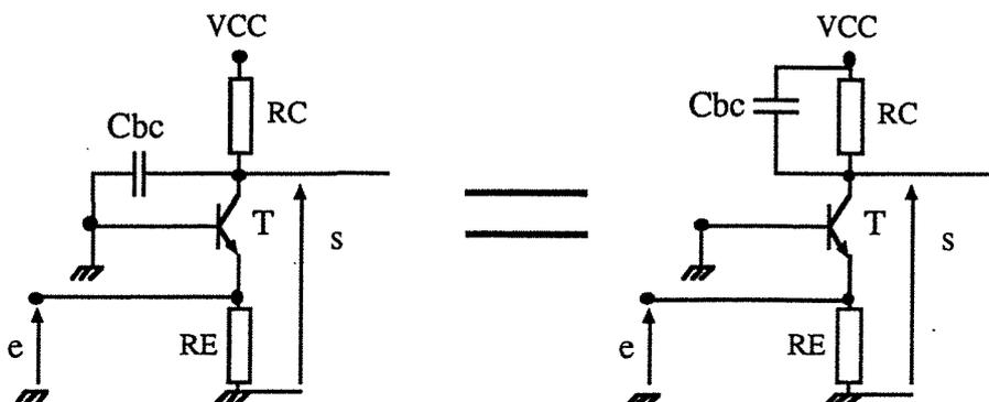
**Figure C.10 : Schéma simplifié du transistor en Base Commune**
