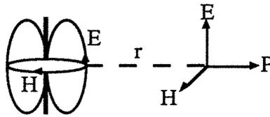
Figure B.4 : Champs créés par un dipôle
