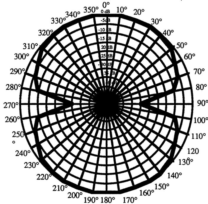
Figure C.3 : Diagramme de rayonnement d'une boucle inductive
