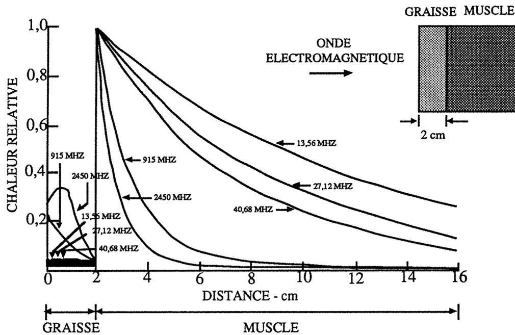
**Figure B.25 : Distance de propagation d'une onde e.m. en fonction de sa fréquence**
