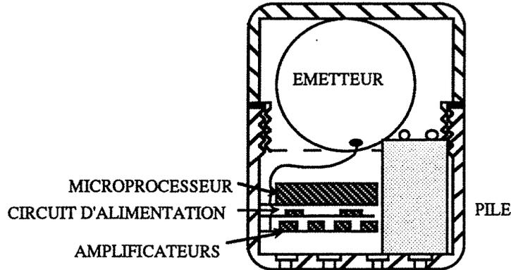
Figure C.26 : Disposition des circuits à l'intérieur du boîtier.
