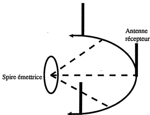
Figure C.2 : Directivité de l'antenne émettrice
