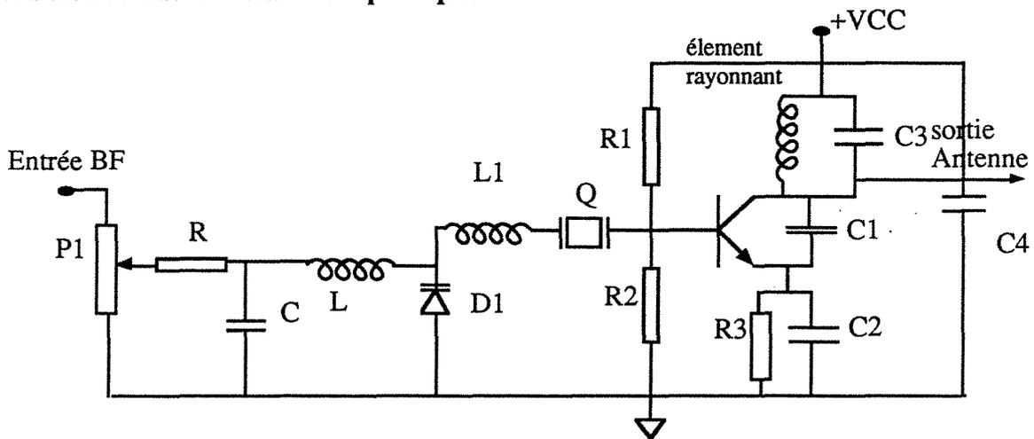
Figure C.15 : Emetteur F.M. stabilisé par quartz
