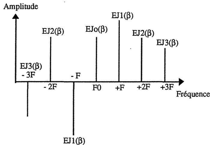
Figure B.15 : Spectre d'amplitude d'un signal F.M.
