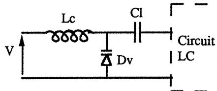
Figure B.32 : Modulateur à diode Varicap
