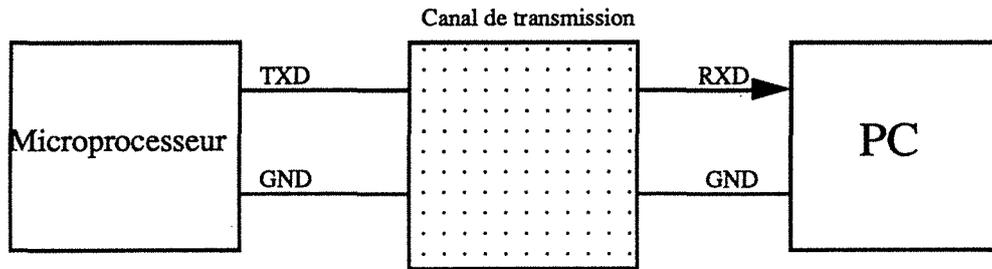
Figure B.54 : Liaison unidirectionnelle
