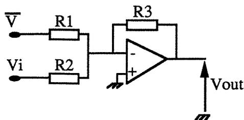
Figure C.29 : Montage additionneur
