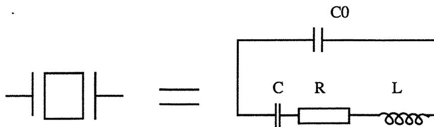
Figure B.28 : Schéma électrique équivalent
