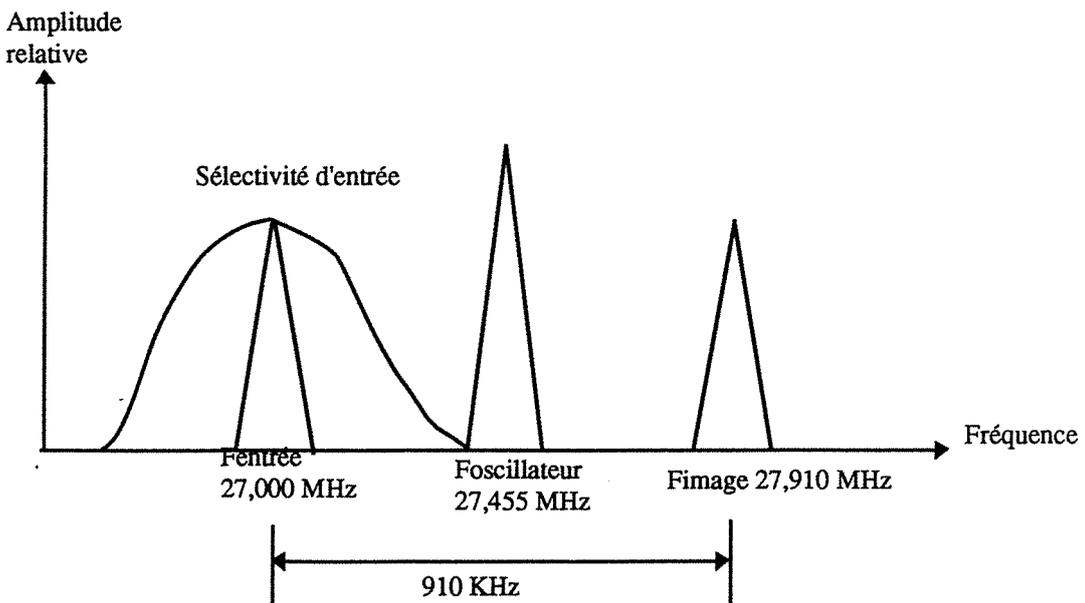
Figure B.45 : Conversion supradyne d'un récepteur 27 MHz
