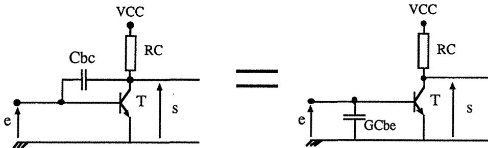
**Figure C.9 : Schéma simplifié du transistor en Emetteur Commun.**
