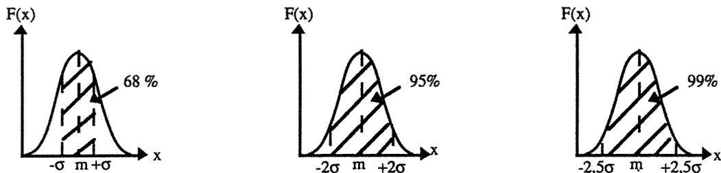
Figure D.15 : Densité de probabilité
