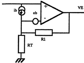
Figure C.21 : Etage adaptateur/amplificateur
