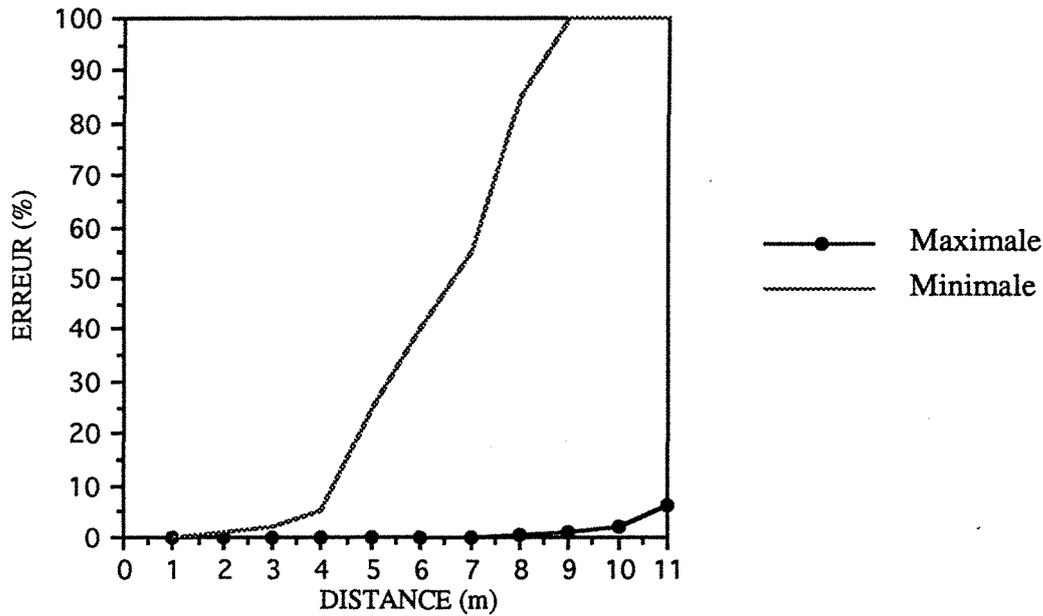
**Figure D.11 : Influence de la position de l'antenne émettrice sur le pourcentage d'erreur.**
