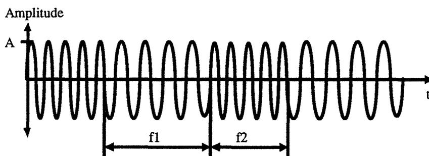
Figure B.18 : Représentation temporelle d'un signal F.S.K.
