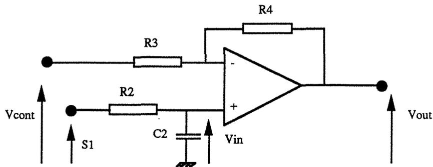
Fig C.18 : Schéma de l'amplificateur-additionneur
