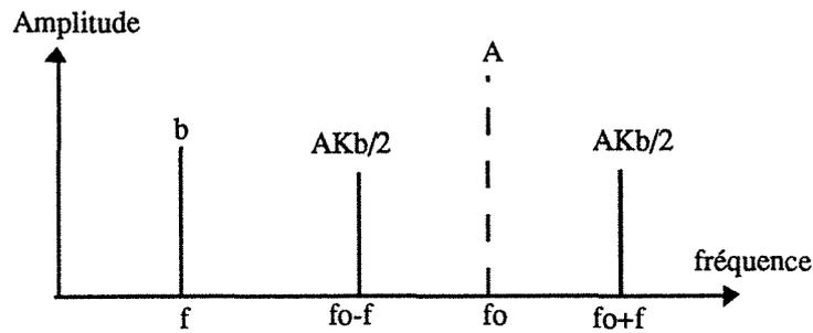
Figure B.13 : Spectre d'amplitude d'un signal A.M.
