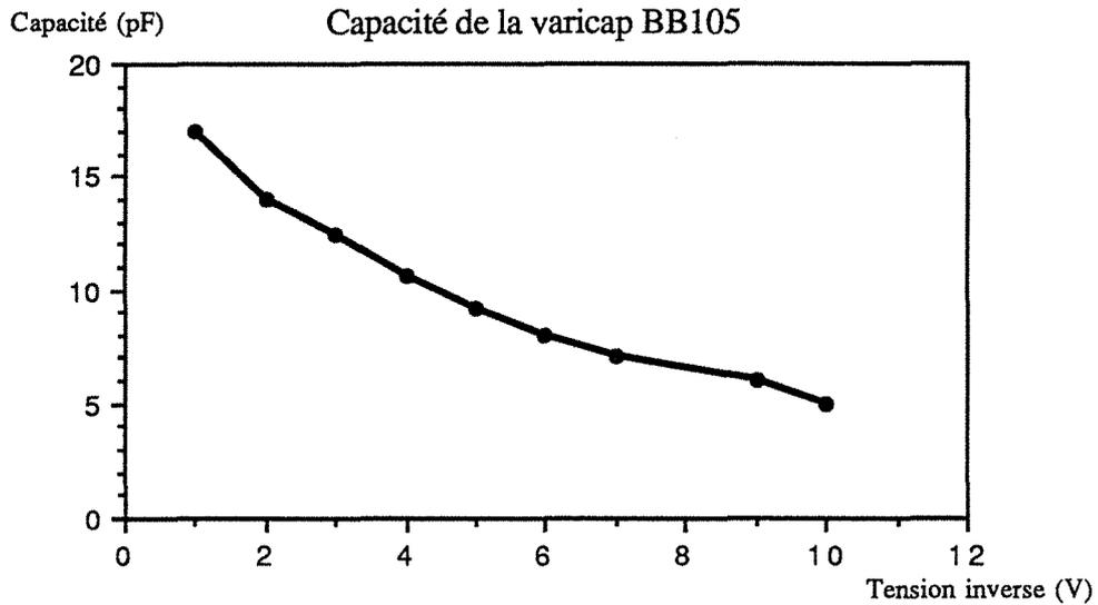
**Figure C.12 : Caractéristique de la varicap BB105.**
