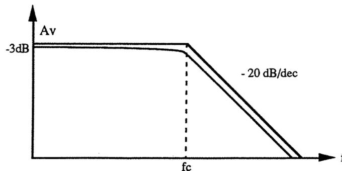
Figure C.19 : Fonction de transfert du filtre passe bas
