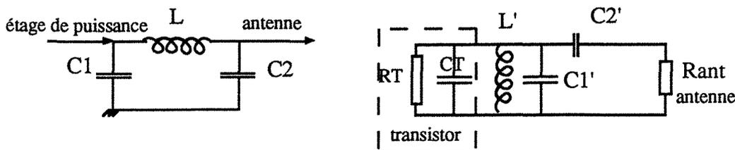
Figure B.34 : Filtres passe bas - Adaptateurs d'impédance
