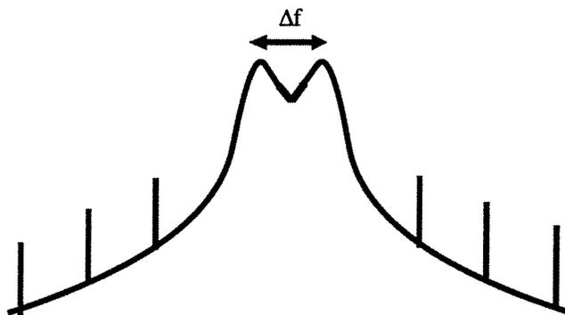
Figure D.2 : Représentation spectrale pratique d'une modulation F.S.K.
