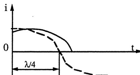
**Figure B.8 : Distribution de courant lorsque  $L > \lambda/2$**
