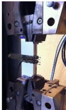
Figure 4.4 : Essai de traction
