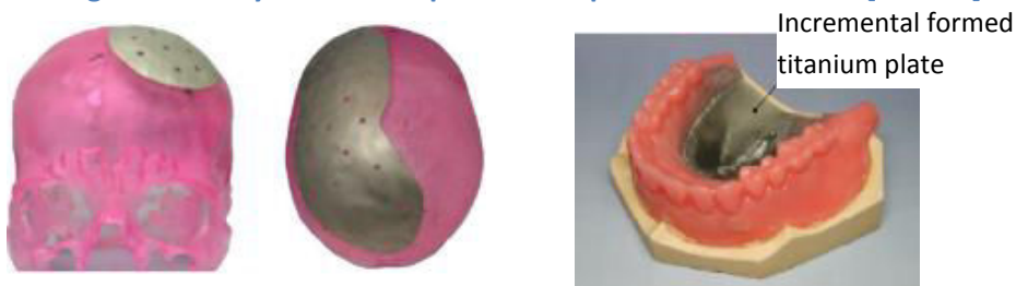
Figure 1.16 : Application du formage incrémental dans le milieu médical : a) Implant crânien [Dul05] b) Implant dentaire [Tan05]
