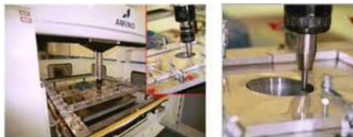
Figure 1.2 : Machine de formage incrémental de la société AMINO Corporation
