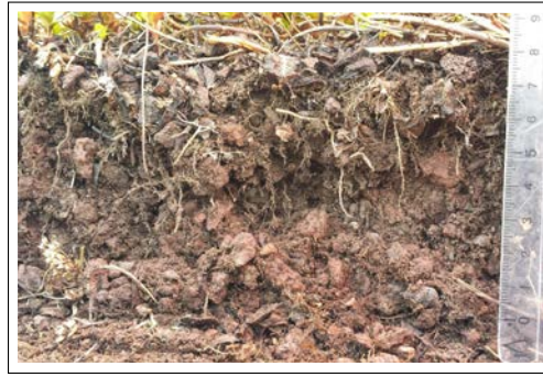
FIGURE 4.17 – Photographie du profil racinaire de la parcelle Stock40 de la toiture végétalisée réalisée le 06/06/2014
