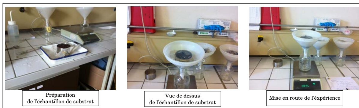
FIGURE 3.6 – Essai de détermination de la teneur en eau à capacité au champ en réalisé sur un échantillon de substrat des parcelles argile expansé et stockage 60 mm. La figure de gauche représente l'insertion du substrat dans le cylindre. La figure du milieu représente les différents éléments utilisés pour l'expérience. La figure de droite représente l'essai en cours d'exécution
