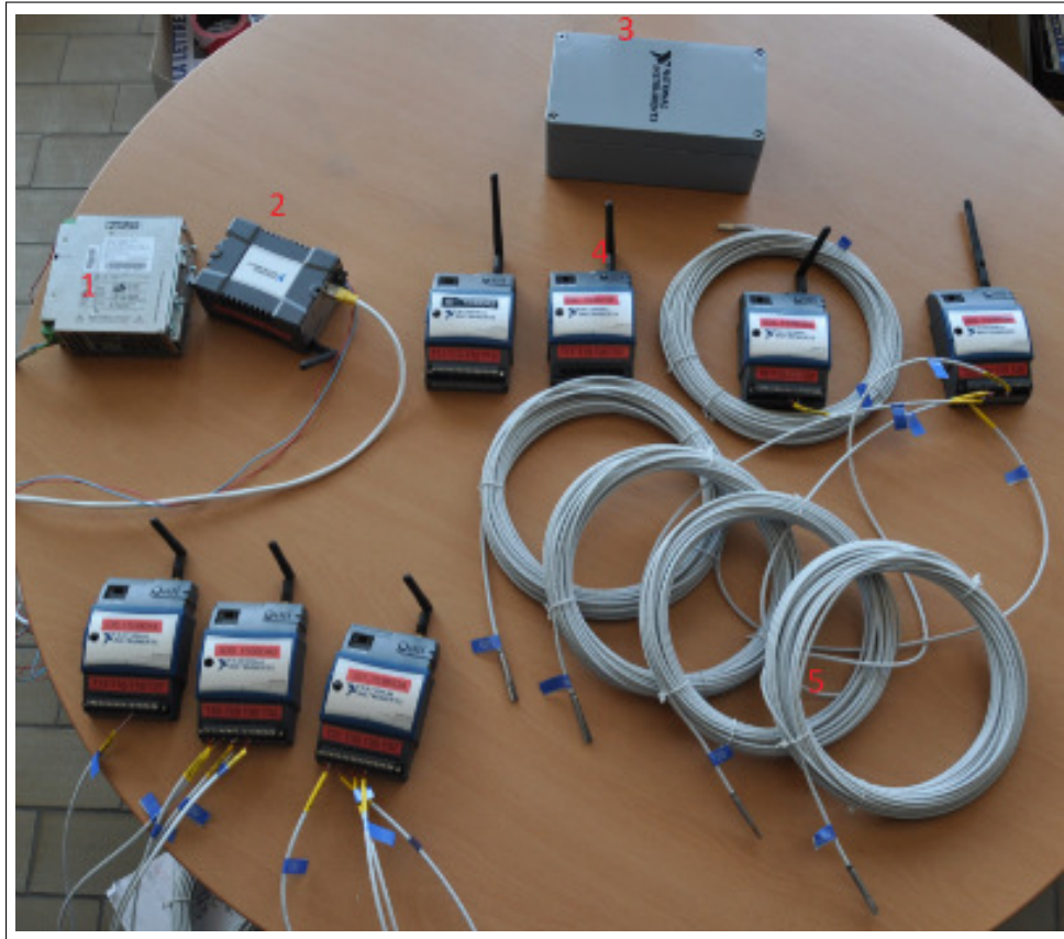
FIGURE C.2 – Photographie de l'ensemble ; sondes de température et système d'acquisition pour la toiture du LRN : 1 : Alimentation pour NI WSN 3791, 2 : NI WSN 3791 Ethernet Gateway, 3 : NI WSN 3291, Protection extérieure de NI WSN 3226, 4 : NI WSN 3226 Nodes, 5 : Thermo-Est Sondes PT100
