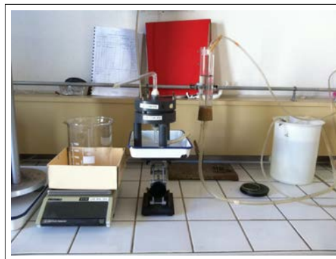
FIGURE B.5 – Dispositif de mesure de la conductivité hydraulique avec un perméamètre à charge constante
