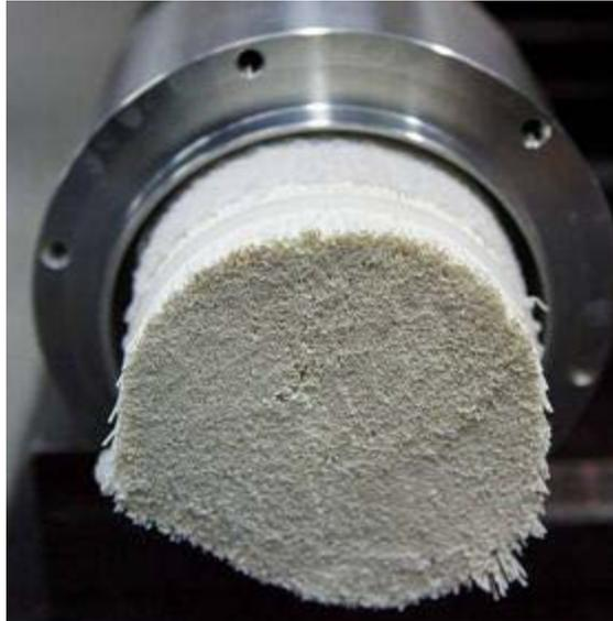
*Figure I-15. Module à fibres creuses*
