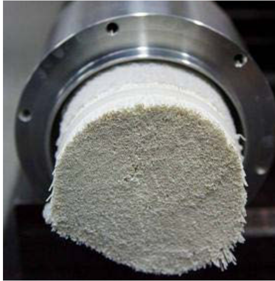
Figure I-15. Module à fibres creuses
