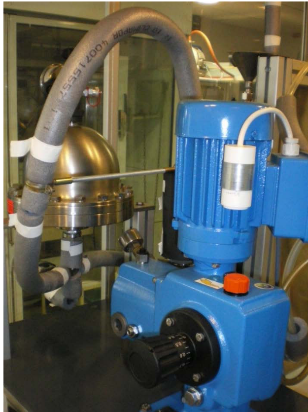
Figure III-10. Photo de la pompe de circulation et de l'amortisseur de pulsations
