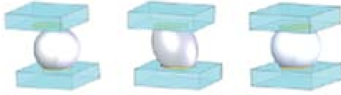
Figure II.12 – Auto-alignement et rattrapage de planéité [II_7]
