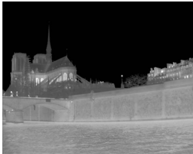
Figure II.7 – Image de la cathédrale Notre Dame obtenue par une caméra IR 8 \mu\text{m} [Laboratoire Pierre Aigrain - UMR 8551]
