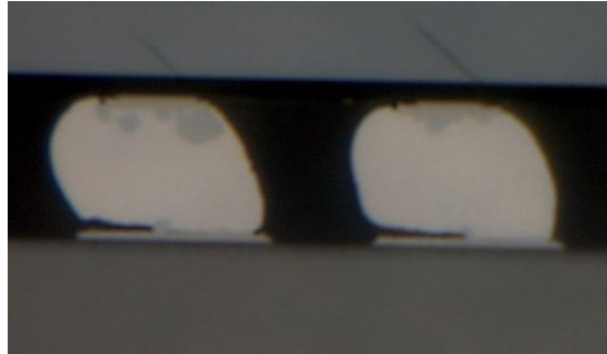
Figure VI.38 – Image MEB de la couche d'interconnexion d'un assemblage flip chip mégapixel [VI_1]
