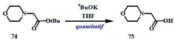
Schéma 75 – Hydrolyse d'ester tert -butylique en présence de tert -butoxyde de potassium
