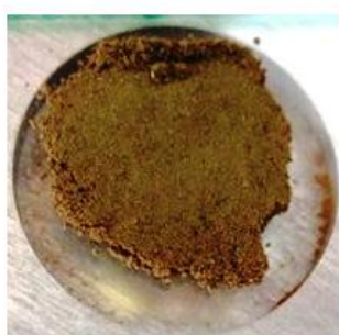
Composé exposé à l'air ambiant pendant 60 min après la déshydratation
