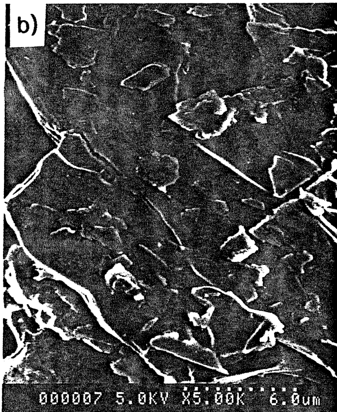
Photos 7.2 : Microscopie électronique à balayage : a) et b) particule de talc 0083 calciné à 1100°C.
