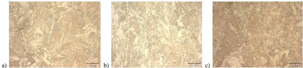
Figure V.1 : Micrographies optiques après attaque Nital 3% de la microstructure  $\alpha$  après déformation à la vitesse de déformation  $\dot{\epsilon} = 10s^{-1}$  et une déformation maximale de a)  $\epsilon=0.15$  et b)  $\epsilon=0.6$ , ainsi que c)  $\dot{\epsilon} = 0.1s^{-1}$  et  $\epsilon=0.6$
