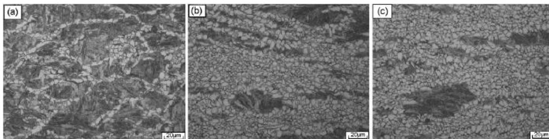
Figure I.38 : Microstructures obtenues par trempe à l'eau directement après déformation à a) \varepsilon=0.36 , b) \varepsilon=0.51 , c) \varepsilon=0.69 avec la vitesse de 1\text{s}^{-1} pour l'acier de composition 0.17\%\text{C}-0.27\%\text{Si}-0.71\%\text{Mn} [Sun08]
