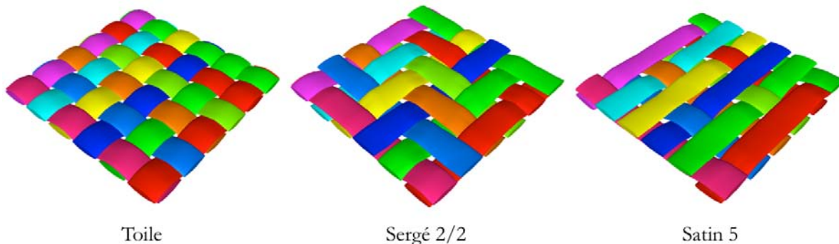
FIGURE 1.4: Trois principales armures de tissu
