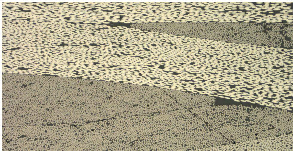
FIGURE 3.9: Zoom permettant d'identifier la forme des fibres et donc les interfaces
