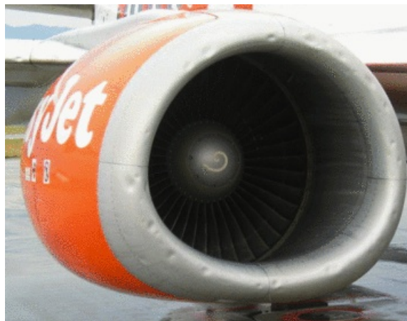
FIGURE 1.3: Entrée d'air endommagée suite à la traversée d'un épisode de grêle.
