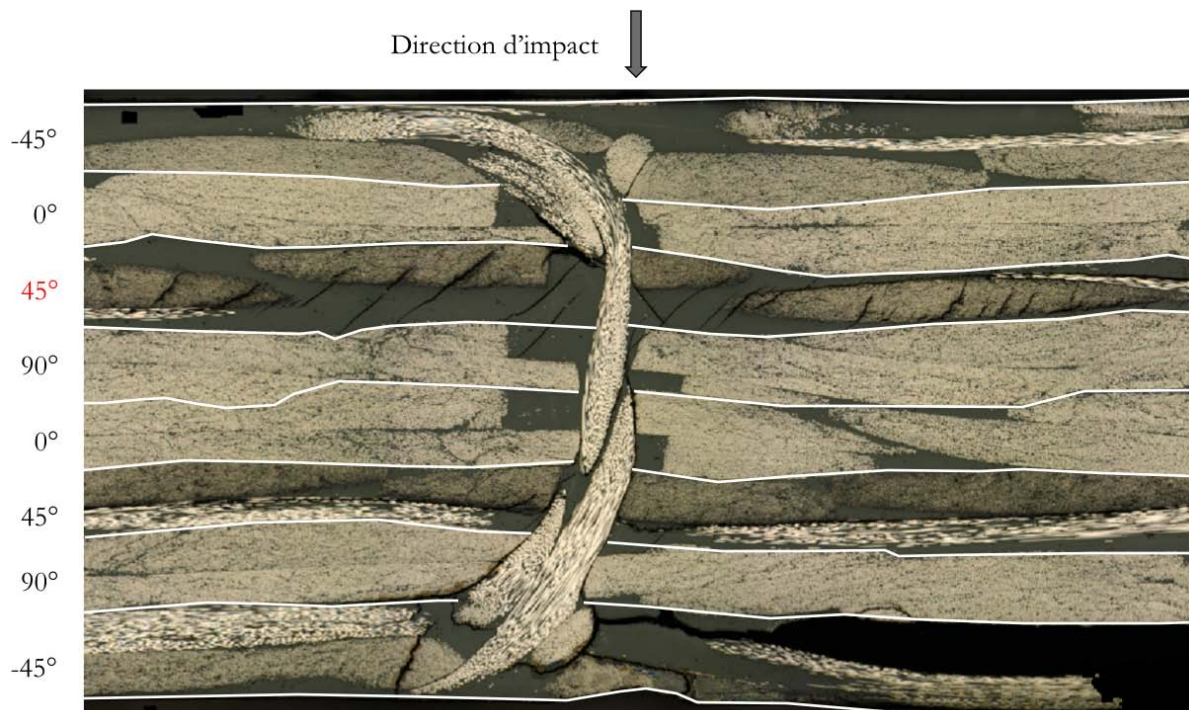
FIGURE 3.26: Observation de fissures transverses au sein d'un pli à 45°
