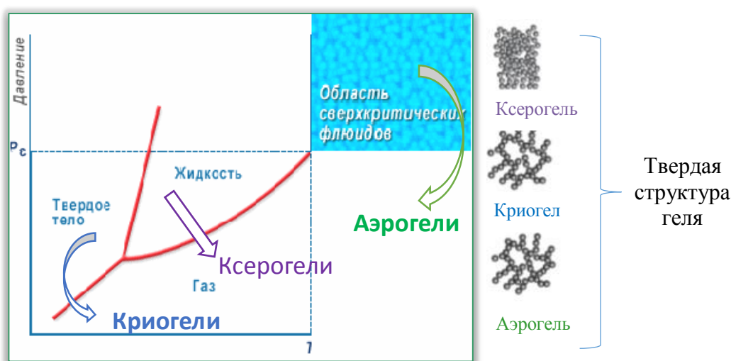
Рис. 1.10 - Диаграмма состояния растворителя внутри геля при различных режимах его сушки и структура полученного пористого материала
