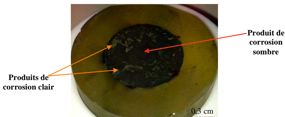
Figure 63. Aspect noirâtre avec des zones plus claires de la surface du coupon d'acier non allié surmonté d'une bicouche de magnétite/(sidérite-chukanovite) après trois semaines d'incubation avec la souche réductrice des nitrates Klebsiella mobilis en présence de lactate (10 mM), nitrate (2 mM) et dihydrogène (1 bar).
