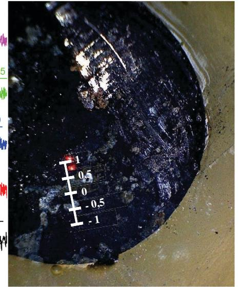
Figure 65. Diffractogrammes pris en différents points de la surface de l'acier non allié recouvert de produits de corrosion mackinawite (Mk), greigite (G), sidérite (S).
