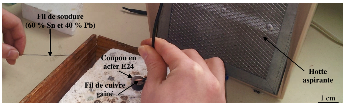
Figure 53. Soudure à l'étain et au plomb d'un fil de cuivre gainé sur la face arrière du cylindre d'acier E24.
