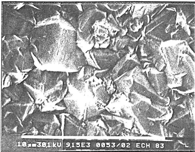
Figure III.56. : échantillon n°33 Topographie d'un film de diamant sur substrat de Silicium prétraité par \alpha -SiC (30 min).
