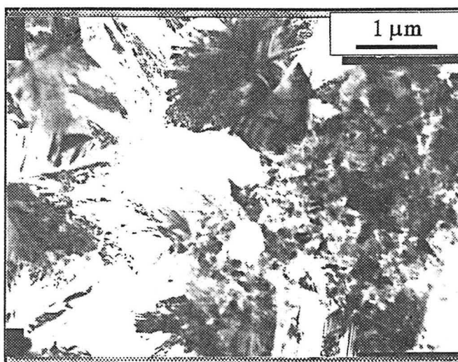
Figure IV.17. : effet de la température/densité de plasma (échantillon n°39) Micrographie en fond clair du dépôt dans la zone d'analyse C. [CH_4] = 0,4 \text{ vol}\% , \bar{T} = 1040 \text{ K} .
