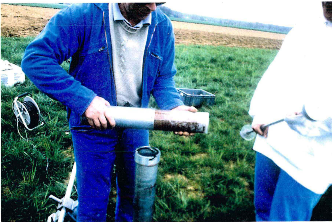
Figure 10 : Prélèvement des échantillons de sol dans des cylindres en plastique de façon à éviter la contamination biologique des différents horizons.
