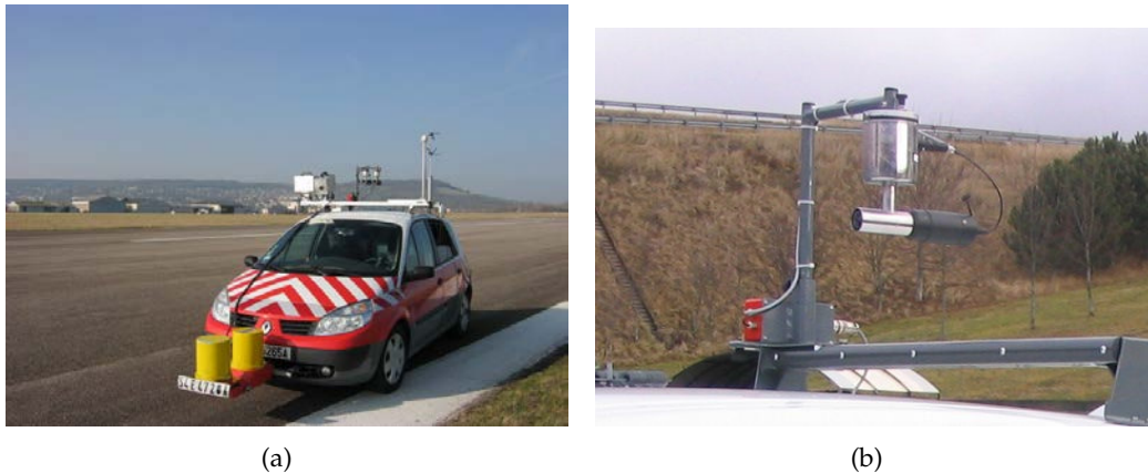
Figure 3.1 : (a) Véhicule instrumenté. (b) Boîtier à effet hélicoïde et système de ventilation.
