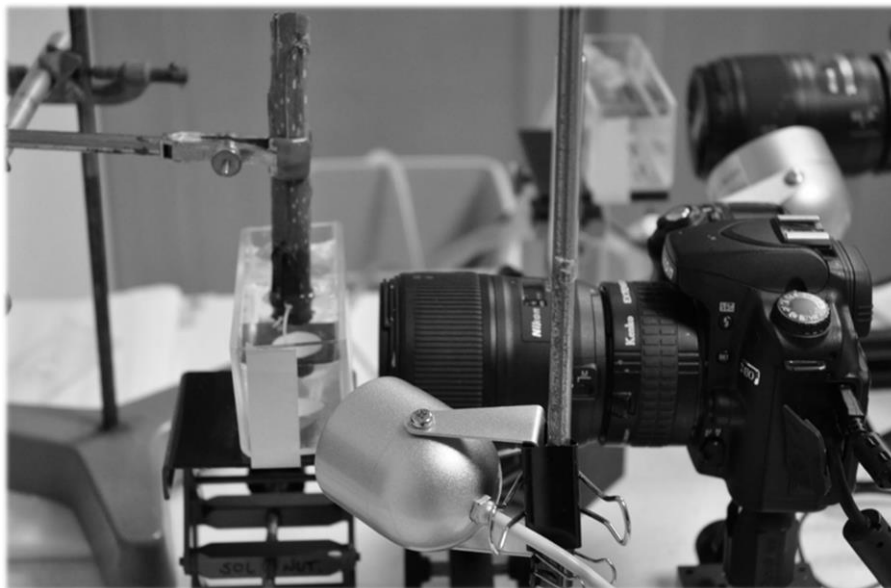
Figure 31 : Dispositif de prise de vue incluant la cuve de suivi, la lampe infrarouge et l'appareil photo numérique fixé sur rail optique. En arrière-plan, une deuxième cuve et un deuxième appareil pour suivre plusieurs un autre racine en parallèle.
