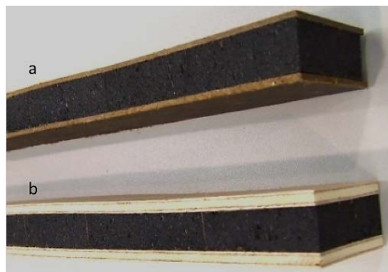
Figure 34 : Sandwich de mousses de tannins de mimosa avec a. des panneaux de fibres de lin et b. des panneaux de contreplaqués
