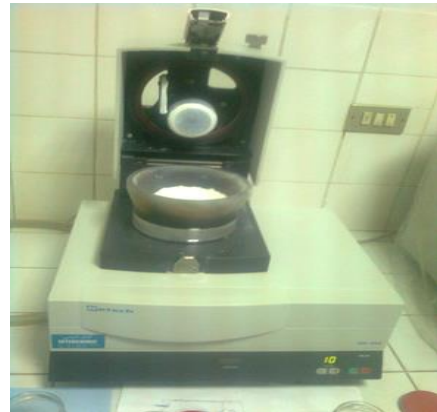
Figure. 51 Opérations de broyage à l'aide broyeur Retsch RM100
