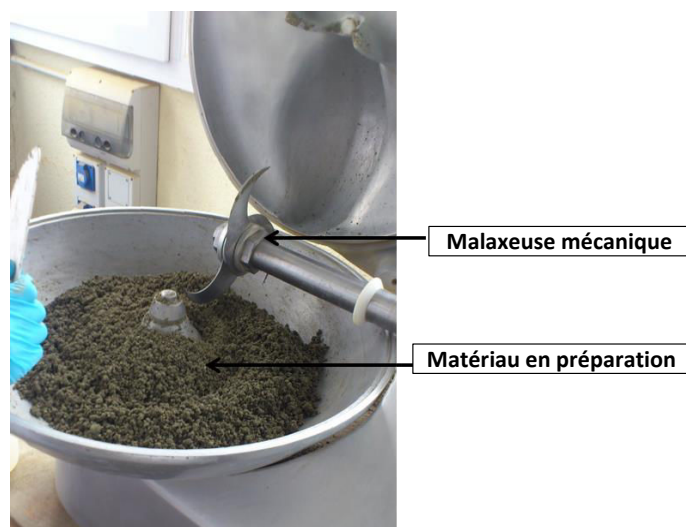
Figure II.3. Malaxeuse mécanique utilisée pour la préparation des sols.
