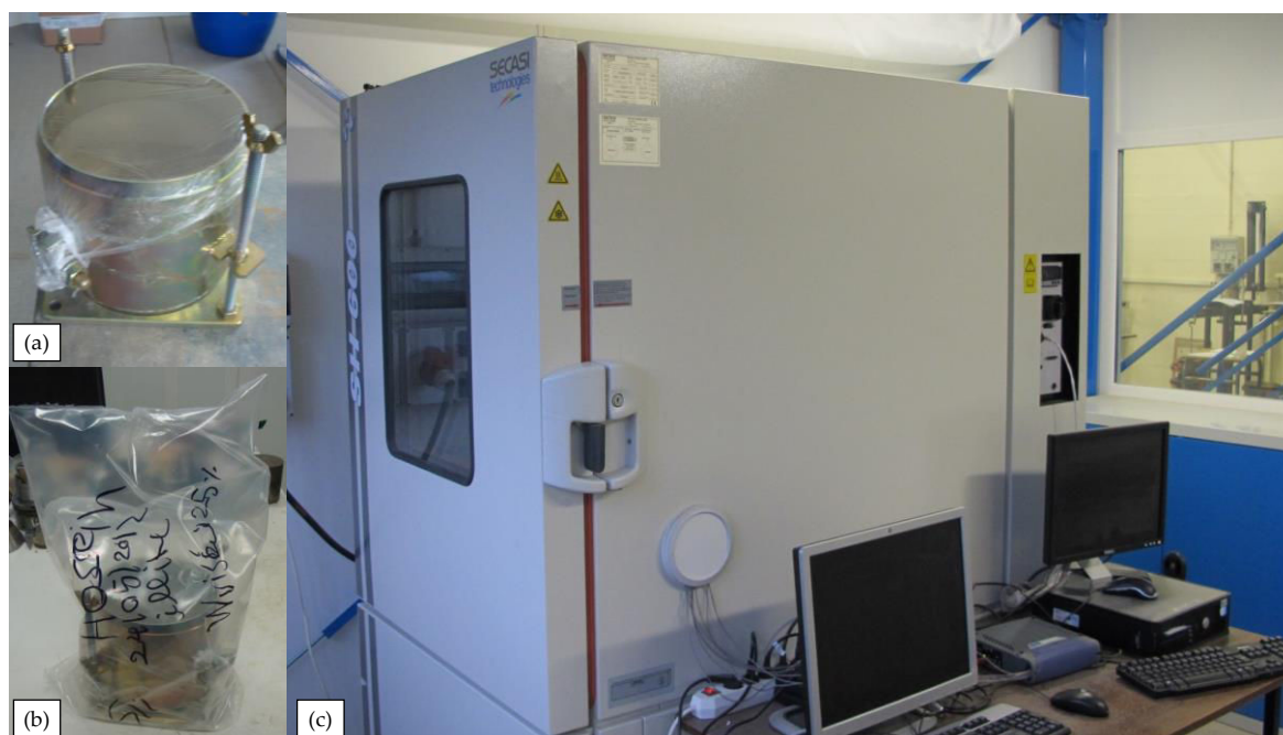
Figure III.3. Isolation du moule après le compactage : (a) moule recouvert de cellophane ; (b) moule dans un sac hermétiques et (c) enceinte climatique.
