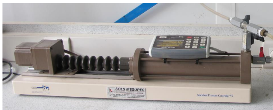
Figure IV.15. Contrôleur pression-volume (GDS Instruments®).
