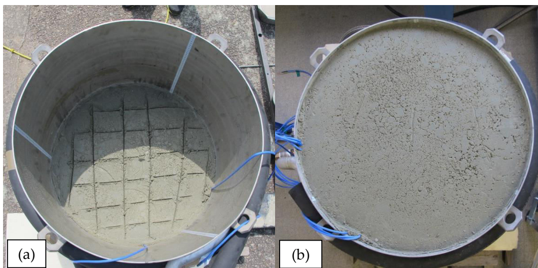
Figure IV.8. Préparation du matériau : (a) surface scarifiée entre deux couches ; (b) surface finale.
