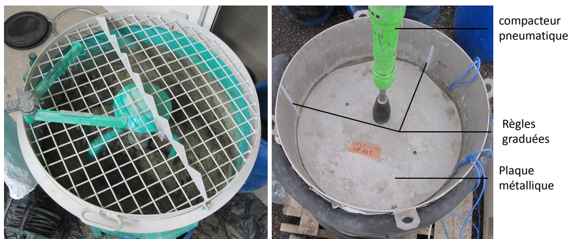
Figure IV.6. Préparation du matériau : (a) malaxage ; (b) compactage dans la cuve.
