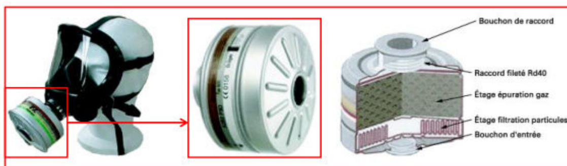
FIGURE 1.1.3 – Schéma d'un filtre anti-gaz
