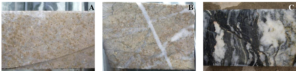
Figure 23 : Photographies des roches encaissantes de la minéralisation aurifère de Nassara. A : Andésites altérées avec pyrites disséminées. B : Andésites altérées minéralisées avec pyrites disséminées et veines de quartz. C : Schiste graphiteux avec pyrites disséminées et aux épontes de veines de quartz partiellement transposées
