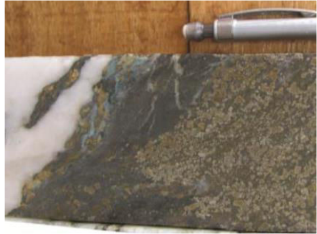
Figure 28 : Pyrites de deuxième génération disséminées dans la roche encaissante au contact des veines de quartz de deuxième génération
