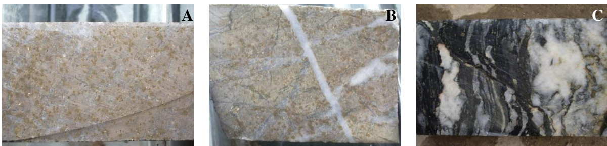
Figure 23 : Photographies des roches encaissantes de la minéralisation aurifère de Nassara. A : Andésites altérées avec pyrites disséminées. B : Andésites altérées minéralisées avec pyrites disséminées et veines de quartz. C : Schiste graphiteux avec pyrites disséminées et aux épontes de veines de quartz partiellement transposées
