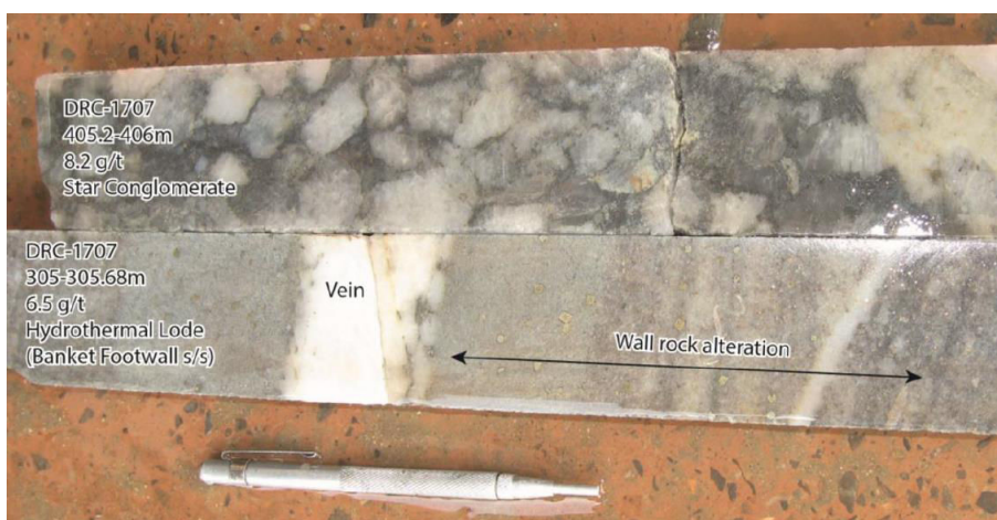
Figure 33 : Photographie de deux carottes de sondage illustrant les deux roches encaissantes de la minéralisation de Damang. En haut : Conglomérat à galets de quartz. En bas : Microdiorite recoupée par des veines de quartz qui s'accompagnent d'une altération de la roche encaissante et de la formation de macrocristaux de pyrite (rapport final WAXI)
