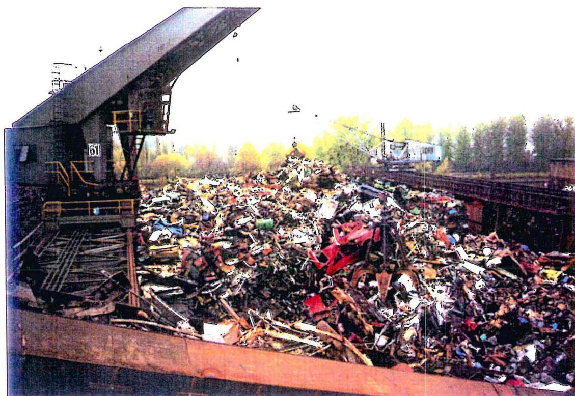
Photo 6 : Chargement du broyeur par grues, montées sur rails
