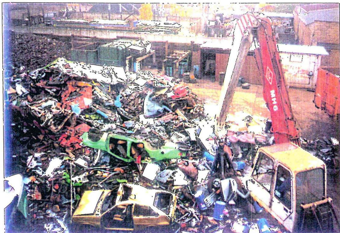
Photo 5 : Formation des tas pour reprise au broyeur
