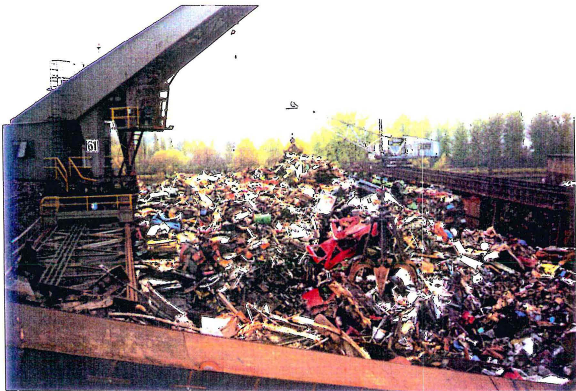
Photo 6 : Chargement du broyeur par grues, montées sur rails
