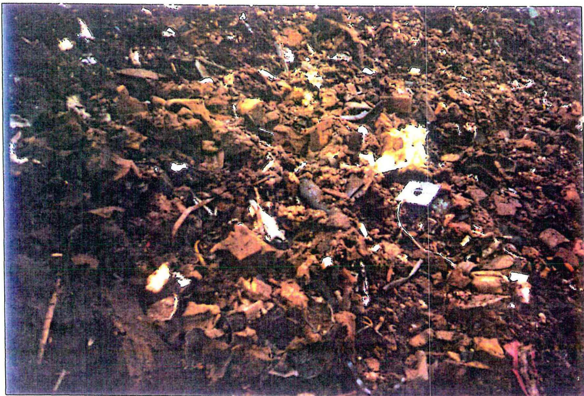
Photo 8 : RBA après broyage et aspiration des légers
