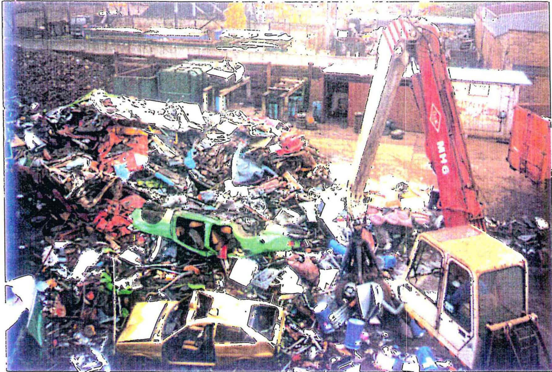
Photo 5 : Formation des tas pour reprise au broyeur
