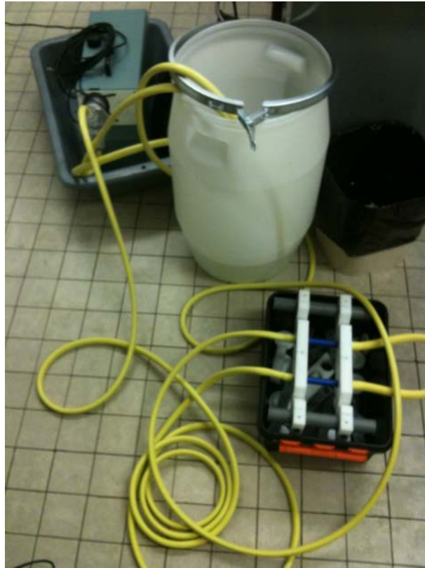
FIGURE 4.2 – Ensemble fantôme de flux, pompe pulsatile, tuyau et réservoir.
