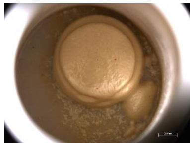
10-a : 60 mol% \text{Bi}_2\text{O}_3 Solide+Liquide
