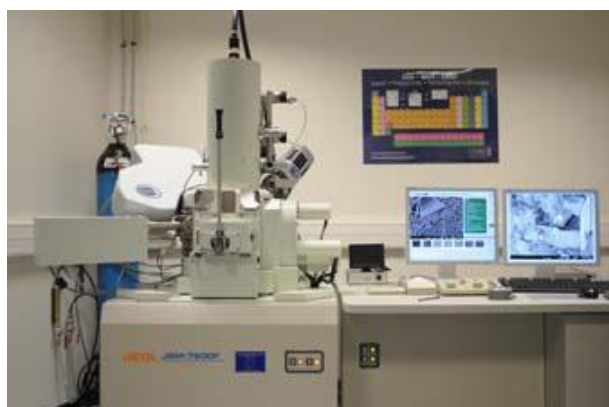
Figure I.2 : Microscope électronique à balayage JEOL JSM-7600F (source SCMEM) *
