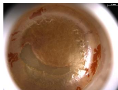
10-d : 98,5 mol% \text{Bi}_2\text{O}_3 Liquide+Solide
