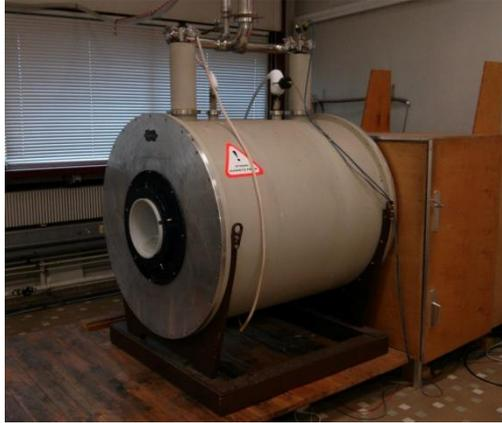
Figure 3-18 : Spectromètre Bruker Biospec installé au laboratoire CRM<sup>2</sup>.
