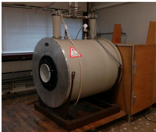
Figure 3-18 : Spectromètre Bruker Biospec installé au laboratoire CRM 2 .
