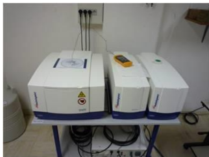
Figure 3-10 : (a) Spectromètre Bruker Minispec mq20, LEMTA. (b) Spectromètre Bruker Avance III, CRM 2 .
