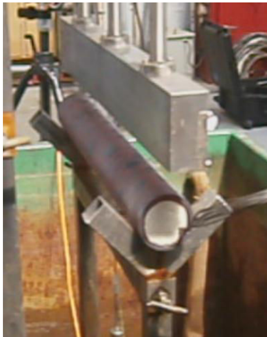
Fig. 4.8 Présence hétérogène de couches de calamine en surface du tube
