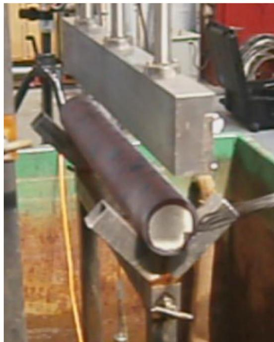
Fig. 4.8 Présence hétérogène de couches de calamine en surface du tube
