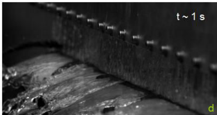
Fig. 4.9 Développement du front de mouillage
