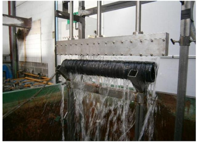
**Fig. 4.2** Buse « jet plan »
