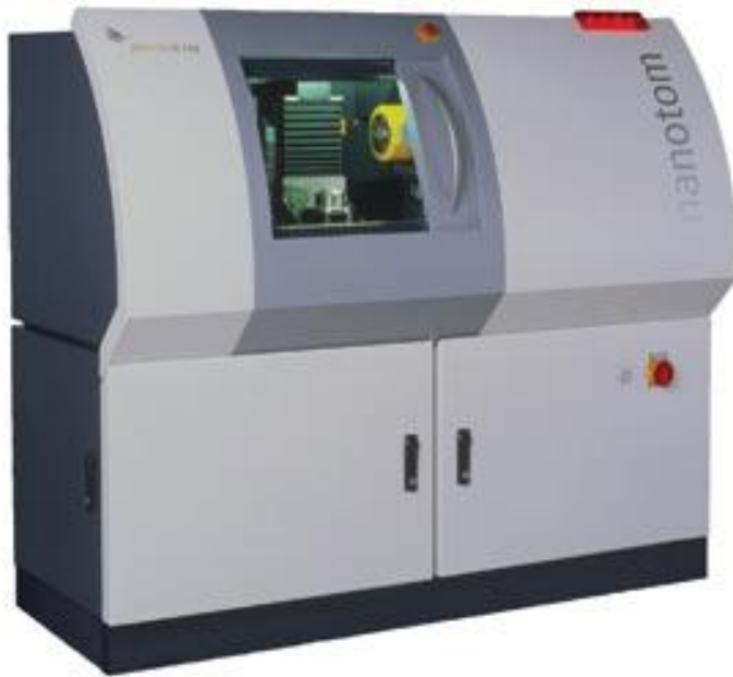
Tomographe à rayons X nanotom Phoenix.
