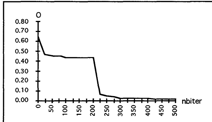
Figure 5.6 Exemple 1 : graphe de O = \frac{1}{2}(O_{adj} + O_{cor}) = f(\text{nombre d'iterations}) , pour un nombre maximal d'itérations de 500.
