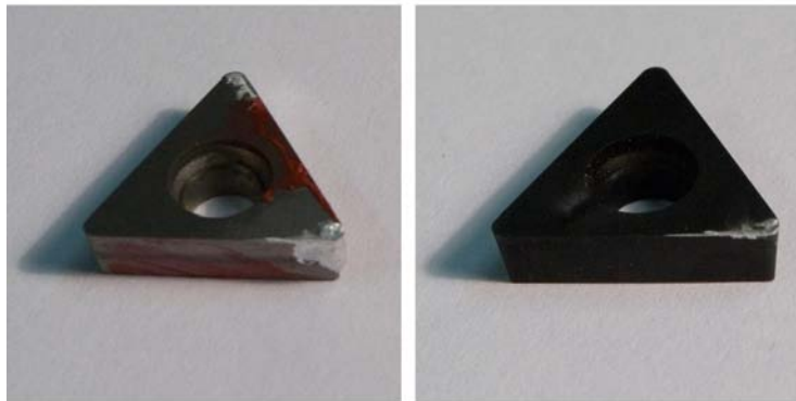
FIG. 2.7: comparaison des plaquettes H13A (a) nue et (b) revêtue diamant après l'usinage d'un alliage aluminium-silicium dans les mêmes conditions
