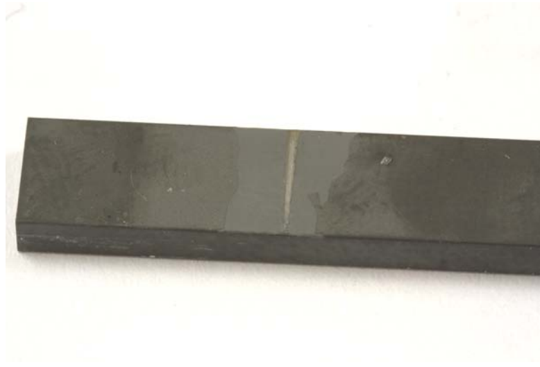
FIG. 4.12: Photo d'un échantillon entaillé après essais de flexion 4 points
