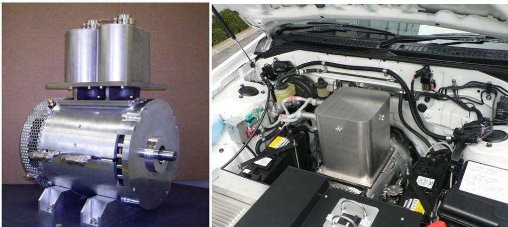
Figure 1-12. Moteur supraconducteur à griffes, 18kW, Sumitomo [OSHK08]
