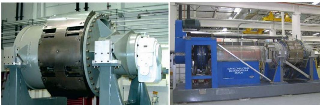
Figure 1-17. Moteur Homopolaire 3,7 MW, GENERAL ATOMICS [CRBS02]
