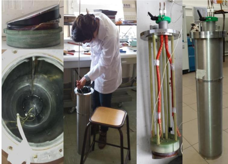
Figure 4-15. Assemblage de l'inducteur supraconducteur
