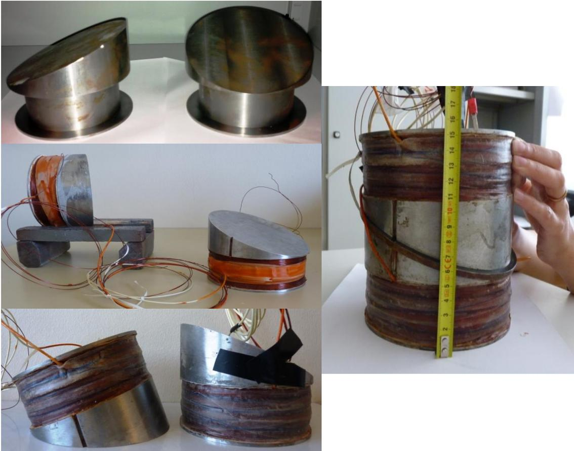
Figure 3-10. Les deux bobines supraconductrices.
