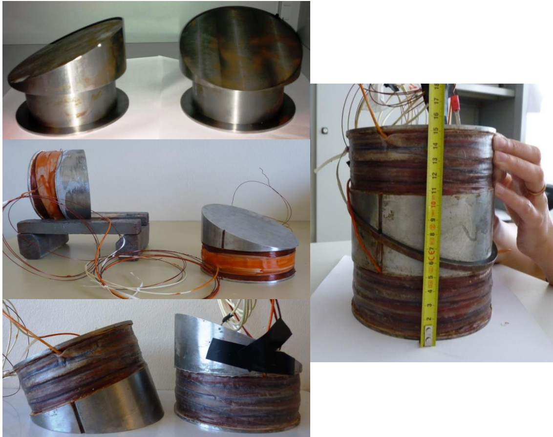
Figure 3-10. Les deux bobines supraconductrices.
