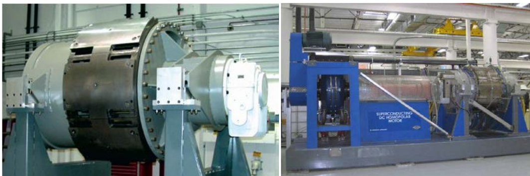
Figure 1-17. Moteur Homopolaire 3,7 MW, GENERAL ATOMICS [CRBS02]
