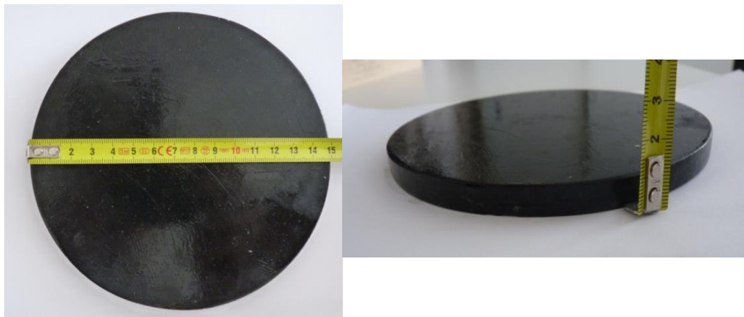
Figure 3-2. Ecran supraconducteur YBCO de diamètre 150 mm et d'épaisseur 10 mm
