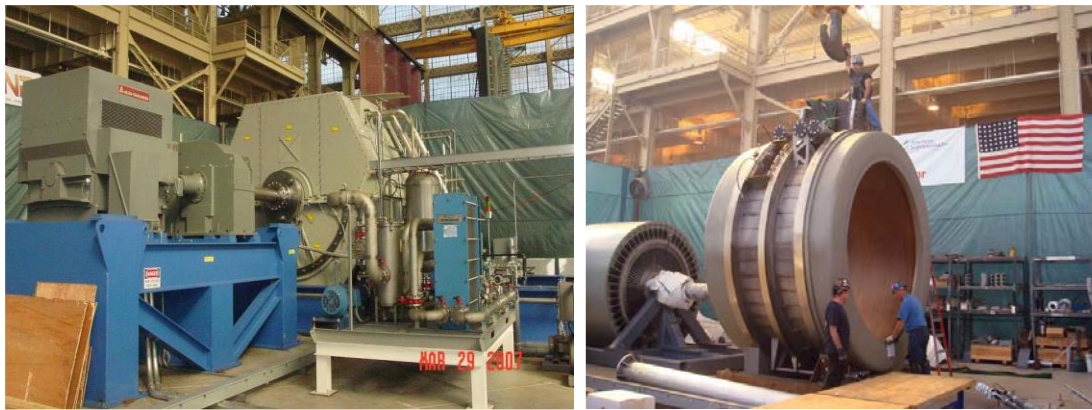
Figure 1-20. Moteur HTC de propulsion de navire 36,5 MW construit par AMSC
