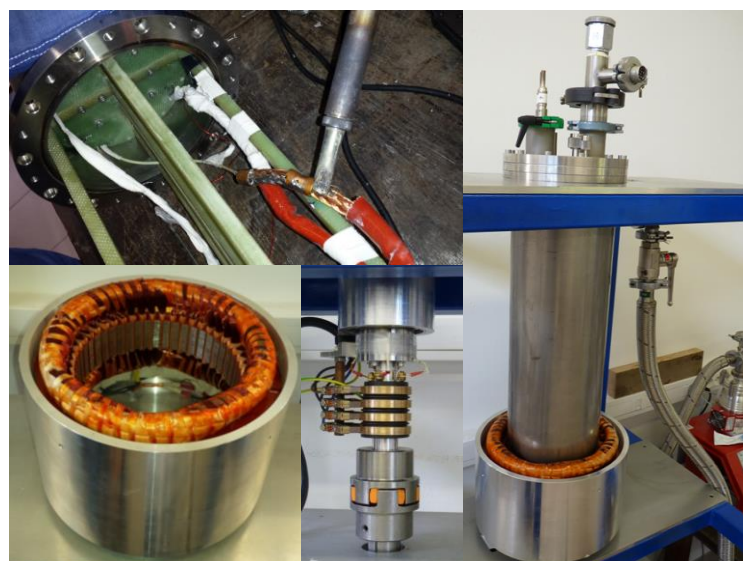
Figure 4-16. Assemblage du système tournant et connexion des amenées du courant
