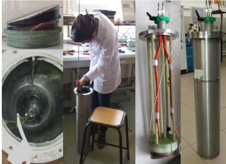
Figure 4-15. Assemblage de l'inducteur supraconducteur
